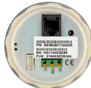
Der veKonvert erkennt automatisch, an welches Victron-Gerät er angeschlossen ist, und passt die ausgegebenen NMEA 2000-Daten entsprechend an. Nachfolgend finden Sie eine Liste der PGNs, die der veKonvert für die verschiedenen Victron-Geräte ausgibt, sowie die verschiedenen Modi, in denen sie betrieben werden können:
